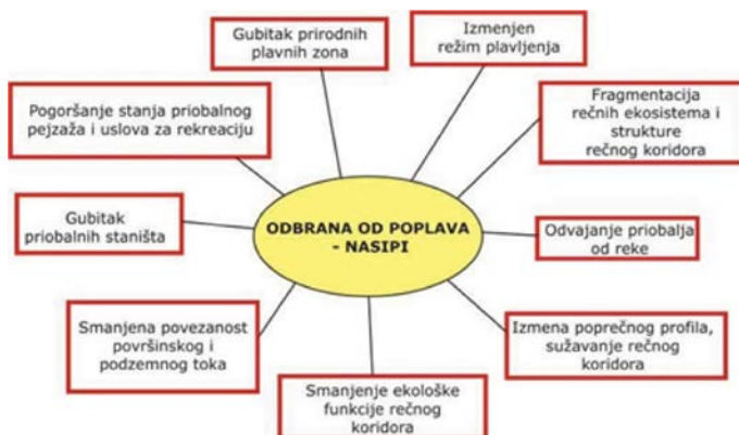
Slika 18.8: Promene na vodnim telima izazvane izgradnjom nasipa [8]
