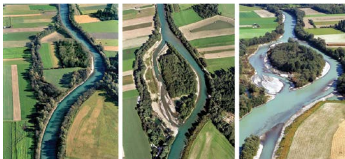
Slika 18.10: Primer renaturalizacije vodotoka – promena poprečnog profila reke Drave u Austriji (Izvor: wau.boku.ac.at)
