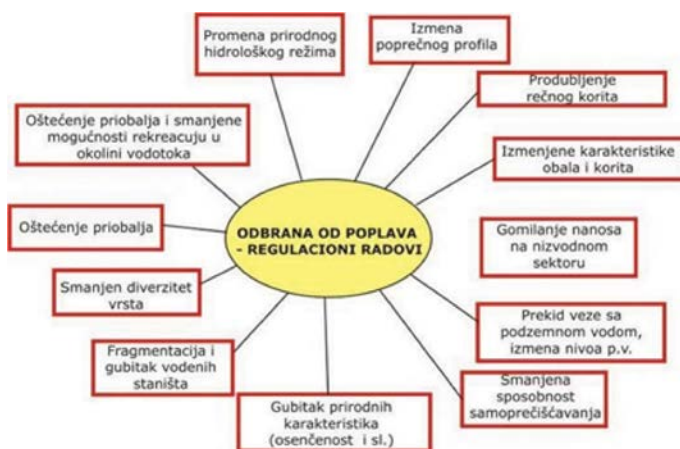
Slika 18.7: Promene na vodnim telima izazvane regulacijom vodotoka [8]
